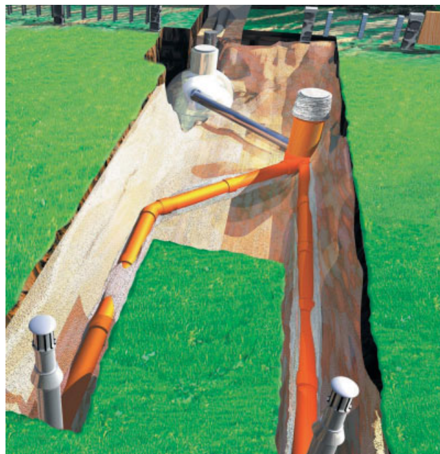
Rys. 1. Schemat indywidualnego układu oczyszczania ścieków
